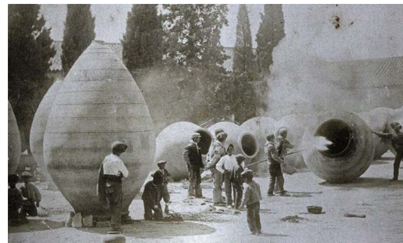
Aplicación de la pez a las tinajas tras su horneado Primer cuarto del siglo XX. Museo Ulpiano Checa. Colmenar de Oreja (Madrid).
